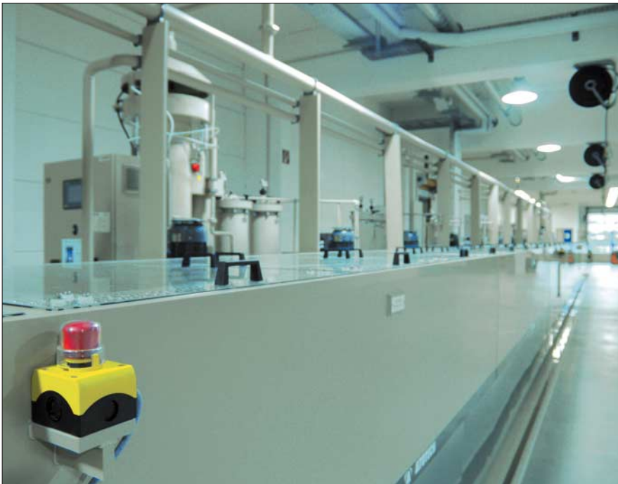
Bild 3: Die Horizontal-Durchlaufanlage mit 30 m Länge
